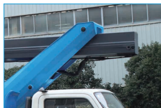
■ 多边形折弯工艺，强度刚度兼备，作业稳定可靠
