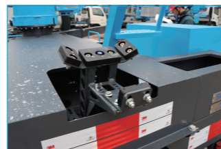
■ 防溜臂托架装置，安全多一道保障
